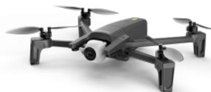
La fonctionnalité « **suivi de cible** » permet de placer systématiquement et automatiquement le sujet à filmer (par exemple le véhicule en tête d'une course automobile) au centre de l'image. Le retour d'image fourni par la caméra permet de connaître les mouvements de la cible dans l'image et d'en déduire les déplacements à imposer à la caméra afin de recentrer automatiquement la cible sur l'image.
